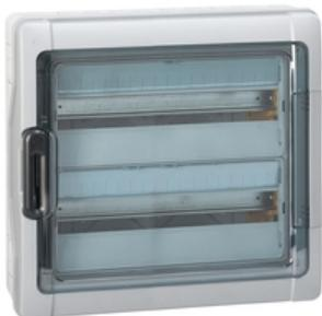
Legrand Feuchtraumverteiler Plexo<sup>3</sup>, Schutzart IP65 - IK09, 2-reihig, 36 Module (18 Module/Reihe), Abmessung 432 x 448 x 161 (Höhe x Breite x Tiefe in mm), selbstverlöschend 650 °C, inklusive N- und PE-Klemmen, Aufputzverteiler Schutzklasse II. Türen transparent, beidseitig anschlagbar. Nach EN 62208, für den Bau von Installationsverteilern nach EN 61439-3.
