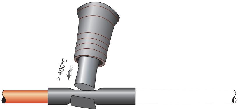
Liitospakkaus on tarkoitettu yksi- tai kaksijohtimellisen TASH tai LAAK (TASSU) -lämmityskaapelin jatkamiseen tai liittämiseen kylmäkaapeliin.
